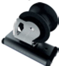
Chariot de génois à billes Delrin & réa simple
