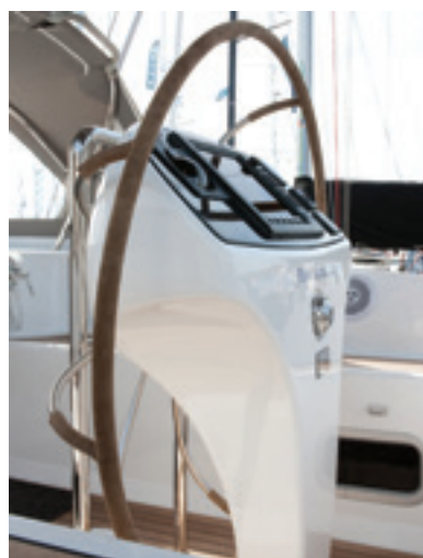
Roue concave custom conçue pour être montée sur la face arrière de la colonne
